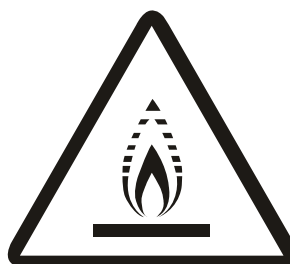
Advarsel: Lav brændehastighedsmateriale (For produkter indeholdende R32 kølemiddel, overhold kun standarden IEC 60335-2-40:2018)
